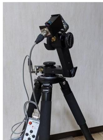
導入精度を高めるためにも水平を正しく合わせておきます。
