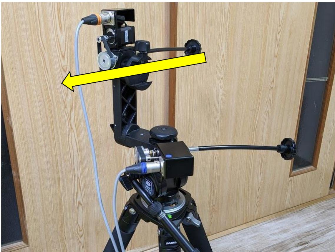
逆方向に取り付けたい場合は、高度のモーターの回転方向を逆にしてください。
