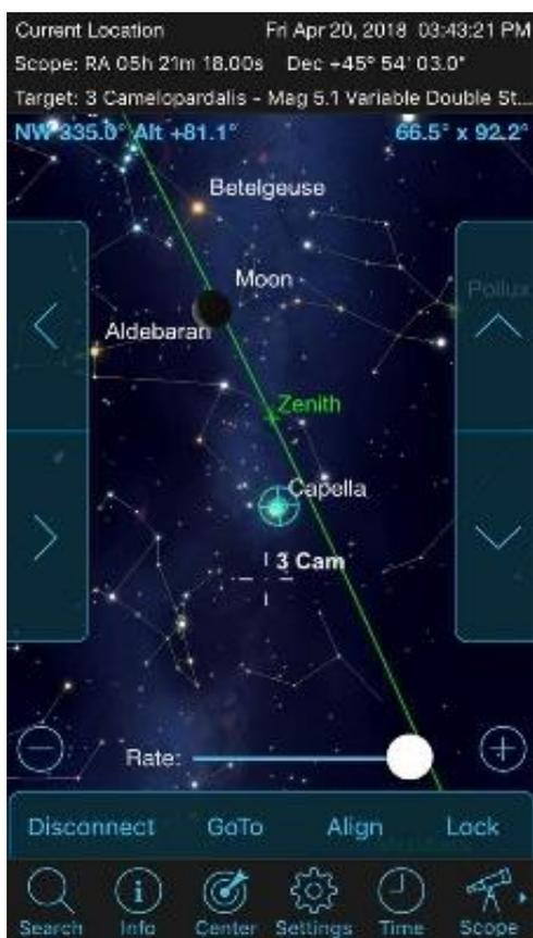
基準の星を望遠鏡で合わせ Align（同期）をします。
