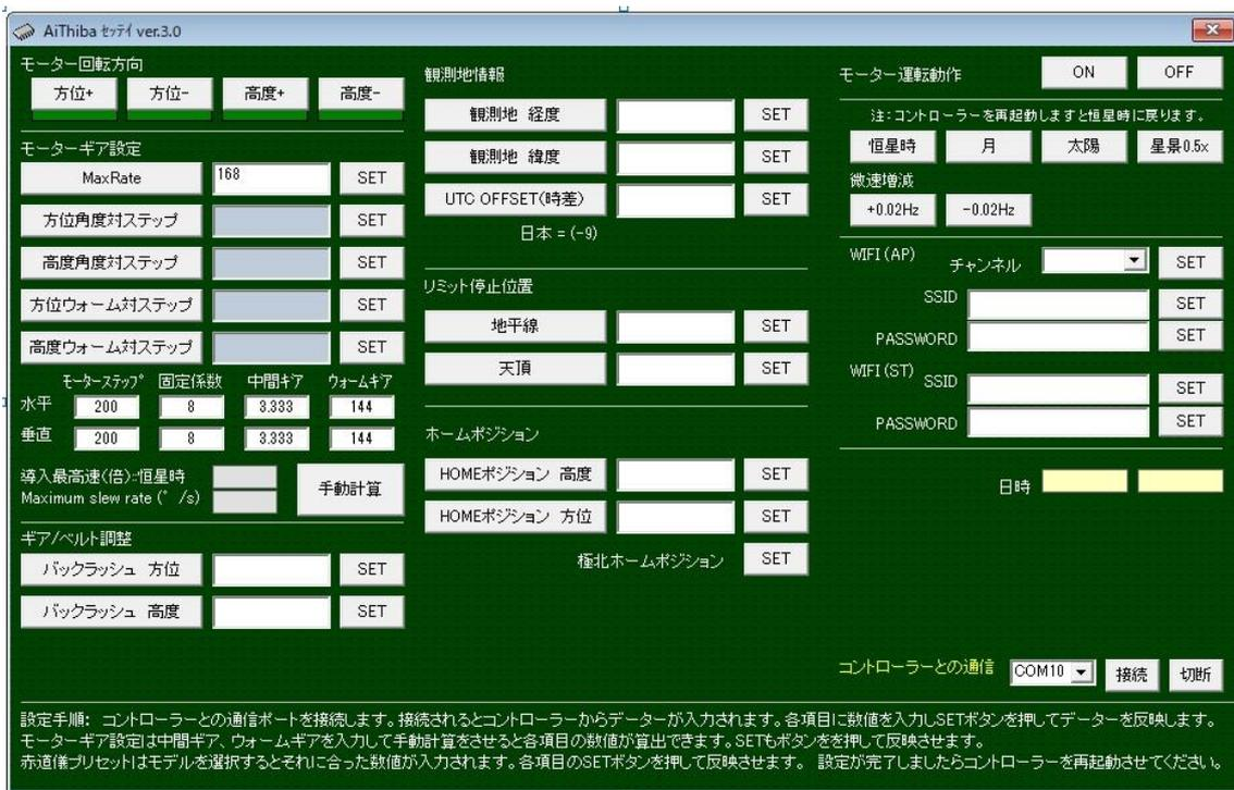
「コントローラーの通信」項目のポートを選択して「接続」をします。
