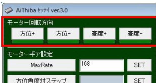
モーターの回転方向は設定アプリで設定します。
